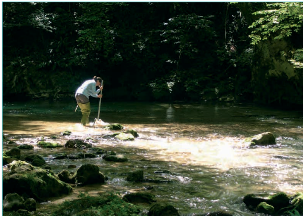
figura 8 Modalità di raccolta dei campioni con la tecnica del kick sampling - FOTO DI V. IANNILLI
